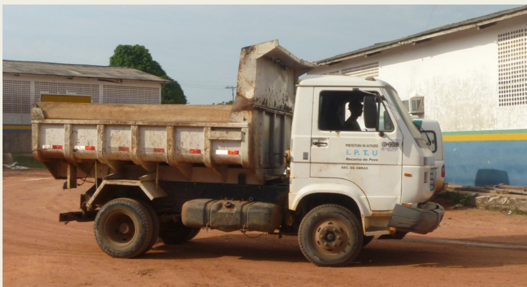
ILUSTRAÇÃO 4.2.3.1: CAÇAMBA UTILIZADA PARA A COLETA DE RESÍDUOS. FOTO: PLAMSAN.
