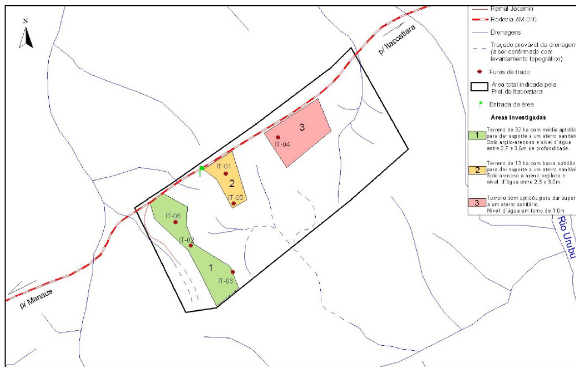
ILUSTRAÇÃO 6.3.1.1: MAPA DE DETALHE DA ÁREA TOTAL INDICADA PELA PREFEITURA DE ITACOATIARA E DAS TRÊS SUB-ÁREAS DEFINIDAS PARA AVALIAÇÃO, COM BASE EM ANÁLISE DE IMAGENS DE SATÉLITE E RADAR E INVESTIGAÇÕES DE CAMPO, COM A LOCALIZAÇÃO DOS FUIROS DE TRADO REALIZADOS EM CADA UMA DELAS. FONTE: CPRM.
