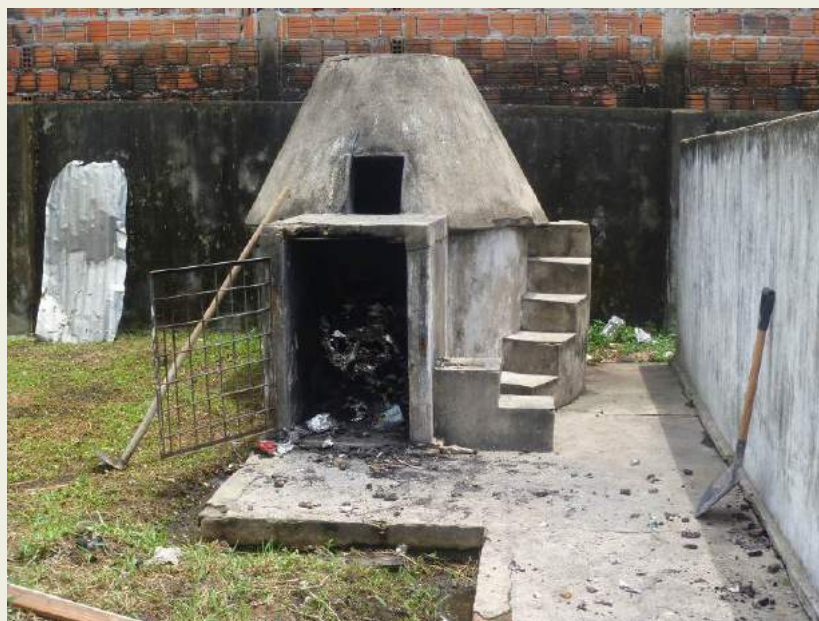
ILUSTRAÇÃO 4.2.3.4- ESPÉCIE DE FORNO UTILIZADO PARA A QUEIMA DE RESÍDUO DOS SERVIÇOS DA SAÚDE EM ITAMARATI/AM. FOTO: PLAMSAN
