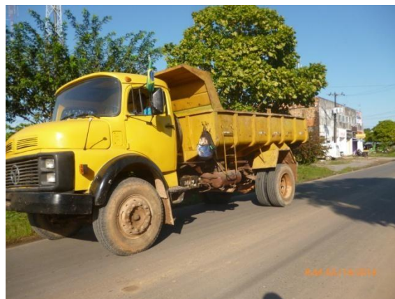
b) Coleta domiciliar – Caçamba de 5m 3 utilizada para os serviços de coleta
